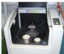
**Scheibenschwingmühle** zum Aufmahlen mineralischer Materialien < 0,063 mm
