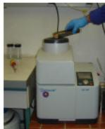
**Ultrazentrifugalmühle** für Kunststoffe und biogene Materialien < 1 mm
