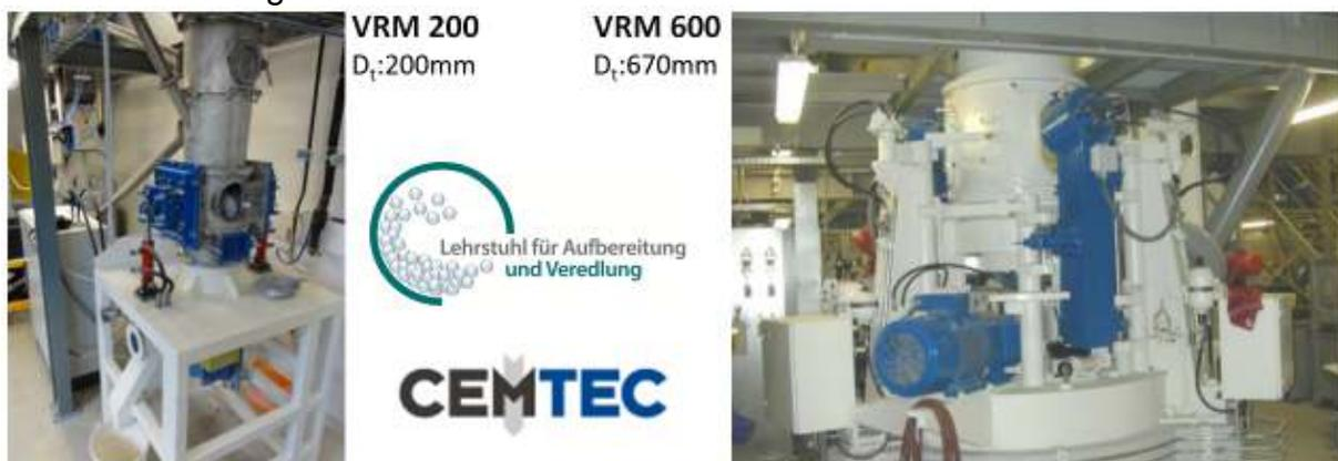
Bild: Verwendete Vertikalmühlen
