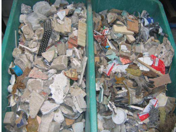
Bild 4: Sortierergebnis von Baumischabfall nach der Röntgensortierung: links die inerte, rechts die heizwertreiche Fraktion
