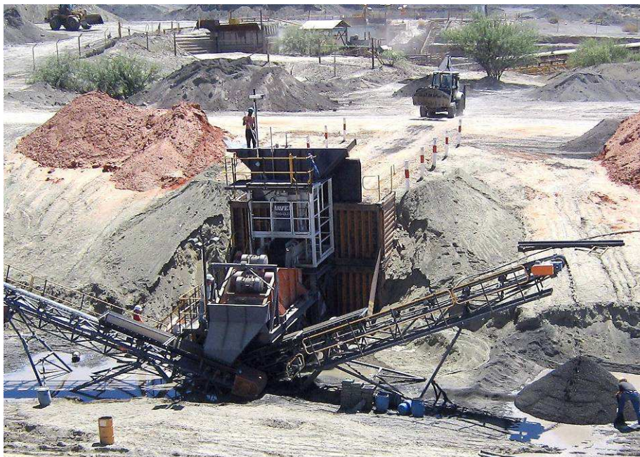
Bild: Die semimobile Pilotanlage für Diamantenaufbereitung ist mit einem HAVER-Hydro-Clean des Typs HC 700 ausgestattet.
