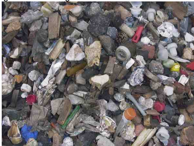
Bild 1: Gesichtete Schwerfraktion mit organischen und anorganischen Bestandteilen – ähnliche Farbe, ähnliche Dichte
