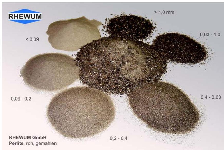
Bild: Siebergebnisse von gemahlenen Perlite (In einem Arbeitsgang mit einer Mehr-Decksiebmaschine MDS erstellte Fraktionen < 90 µm (hell), 90 – 200 µm, 200 – 400 µm, 400 – 630 µm, 630 – 1000 µm und >1000 µm (dunkel), angeordnet um die Aufgabe.
