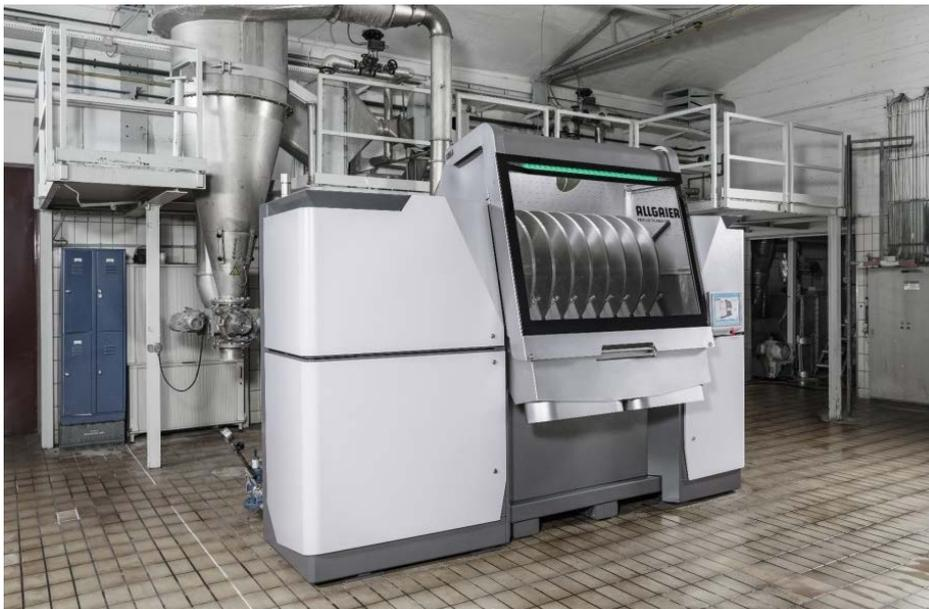
Bild 2: Industrieller CD Dryer 908 zur Abwassertrocknung
