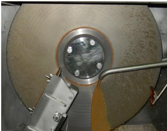
Auf ein sich drehendes und im Innern hohles Scheibenbündel wird mittels sogenannter feed pipes die zu behandelnde Flüssigkeit im Überschuss aufgegeben (Bild 1). Die Flüssigkeit läuft von den Scheiben stetig in einen Vorrats- und Kreislaufbehälter ab und hinterlässt auf den Scheibenoberflächen den zu trocknenden Flüssigkeitsfilm.
