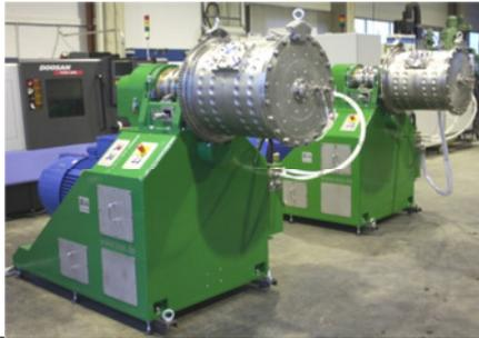
Abb. 1: Simoloyer® CM100b - Hochenergiekugelmühle mit 100 Litern Prozessvolumen
