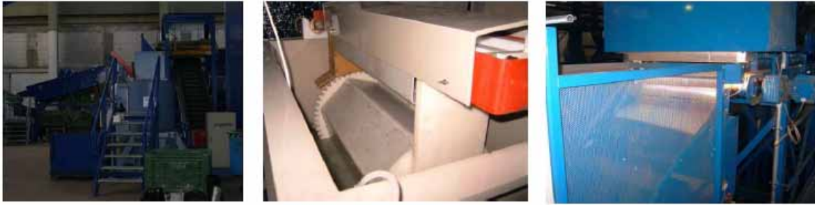
Abb.1 : Demonstrationsanlage (Mechanische Aufbereitung, Bioreaktor, NIR-Sortierung)
