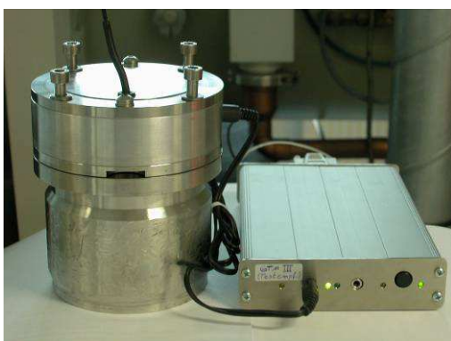
Bild 1: GTM-System: Sensor (montiert auf einem Mahlbehälter) und Empfangssystem (links), Typische GTM-Messung am Beispiel von \text{MoSi}_2 (rechts)
